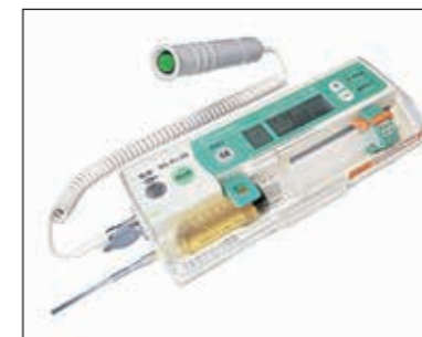
図4 携帯用小型シリンジポンプ。注射をしながら外出や外泊が可能です。
